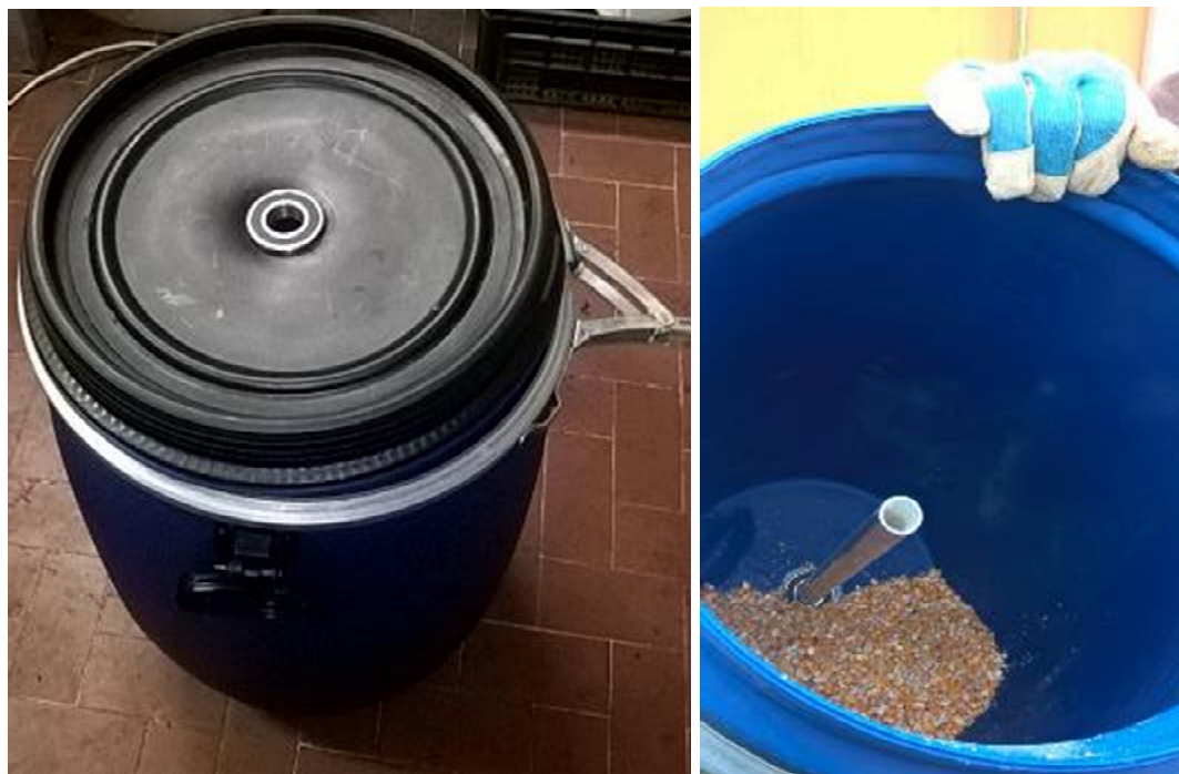
Figura 7.3: Particolari dell'unità di trattamento: a sinistra, plancia di apertura con cuscinetto a sfera; a destra, interno dell'unità di trattamento con asse portante, adduzione e scarico gas in alluminio+PVC.
