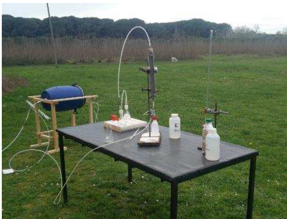
Figura 7.4: Apparecchiatura per la determinazione della concentrazione di O 3 nella miscela gassosa: flussimetro, bottiglie di flussaggio, reagenti e dispositivi di laboratorio per la iodometria.
